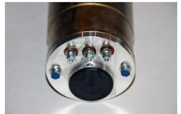
Dynamo C wie die Originale Lichtmaschine bezieht die Masse durch die Gehäuse.
